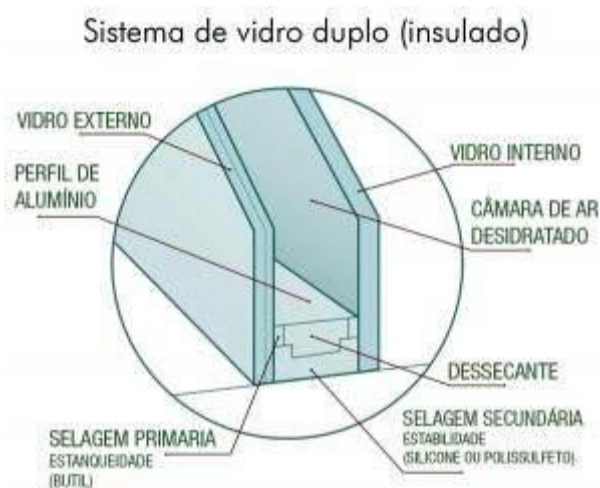
Figura 8 – Esquema de montagem do vidro duplo
