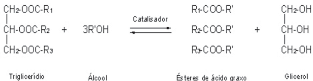
Figura 3.10: Ilustração de uma reação de transesterificação contínua (retirado de Rittner, 1995).
