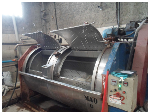
Figura 8: Detalhe da Máquina horizontal de tingimento.
