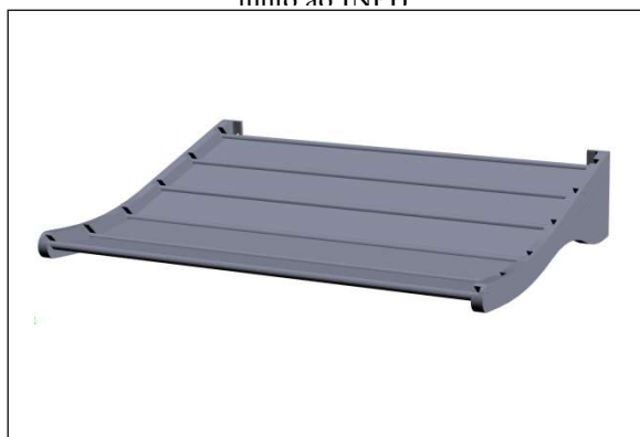
Figura 1: Prateleira de luz arquitetônica oblíqua para iluminação natural (depósito de Desenho Industrial junto ao INPI)
