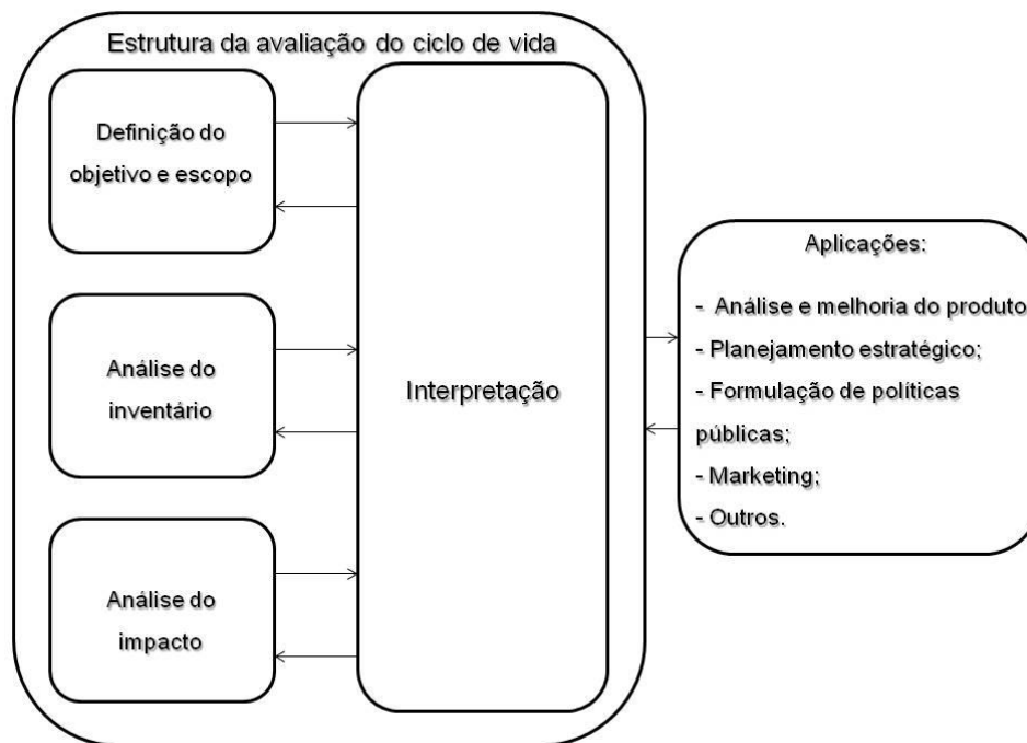
Figura 5.2 - Estágios do estudo ACV. Fonte: (ABNT NBR ISO 14040, 2009)
