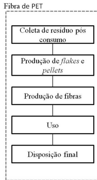
Figura 28 – *Cut-off*: sistema de produto para fibra de garrafa PET
