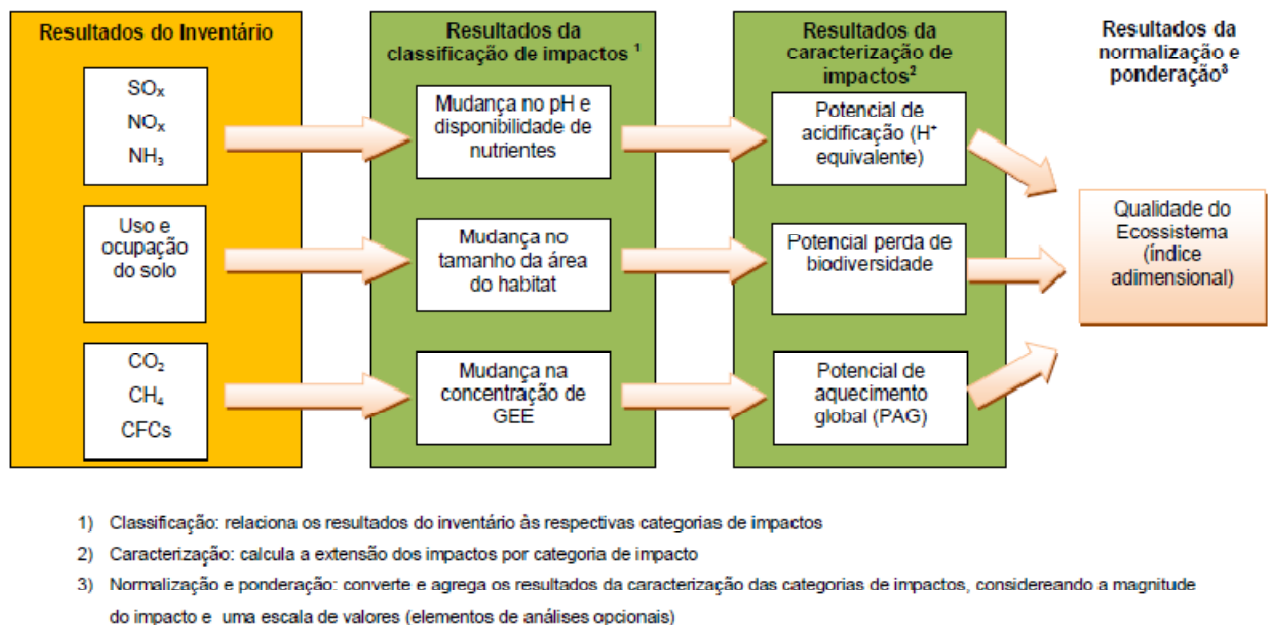
Figura 5.4 – Exemplo simplificado de uma avaliação de impacto do ciclo de vida (FUKUROZAKI, 2011).
