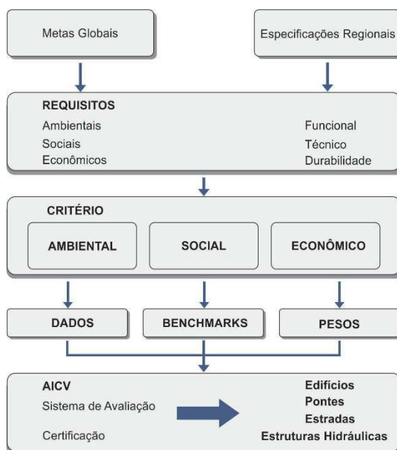
Figura 5: organograma do processo de uma ACVI aplicado em diferentes tipos de estrutura de concreto (fib Bulletin 71, 2013, tradução nossa)
