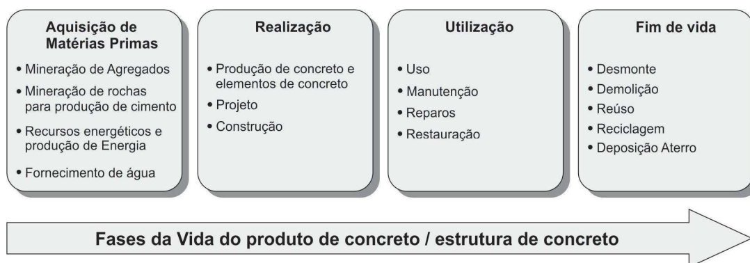
Figura 6: Ciclo de vida da estrutura de concreto (fib Bulletin 71, 2013, tradução nossa)
